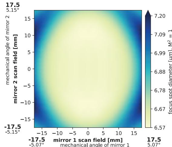
高斯光束 ( $M^2 = 1$ ) 直径为 10.00 mm,  $1/e^2$  时的光斑直径为 86.5%, 光场尺寸为 35.0 mm, 双镜扫描系统的镜面距离如上所示。波长:  $346 + -0.5$  nm (300 fs)
