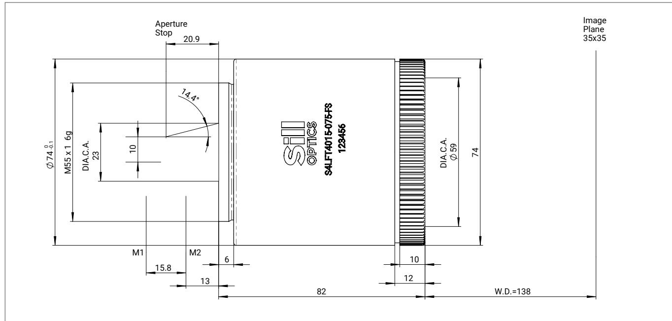
S4LFT4015-075-FS 采用了一种新型消色差技术，只需要熔融石英。因此，与传统的消色差镜片相比，体积、重量和总长度都有所减少，工作距离也得以增加。
