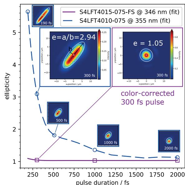
根据脉冲持续时间的不同，显示出扫描区域场角处 psf 的圆度
